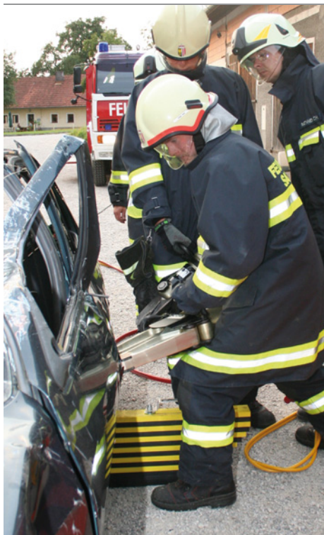
Öffnen einer Fahrertür mit Spreitzer und Schere
