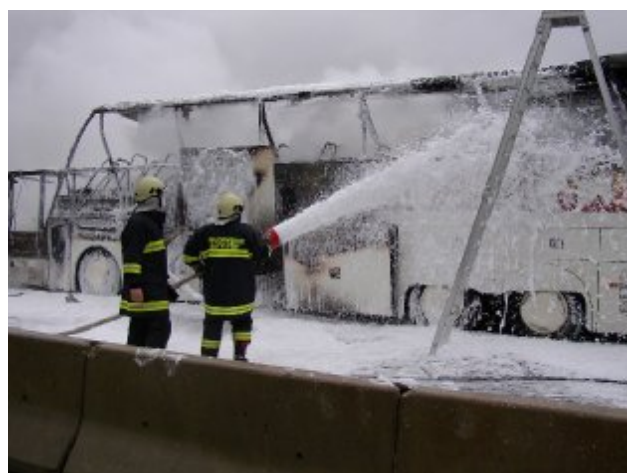
Das Mittelschaumrohr im Brandeinsatz
